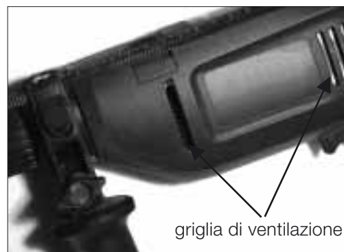
Figura 1: la griglia di ventilazione deve essere libera per impedire il surriscaldamento del motore elettrico.
